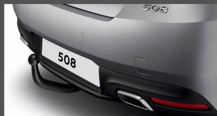
**Фаркоп, демонтируемый без использования инструментов**
